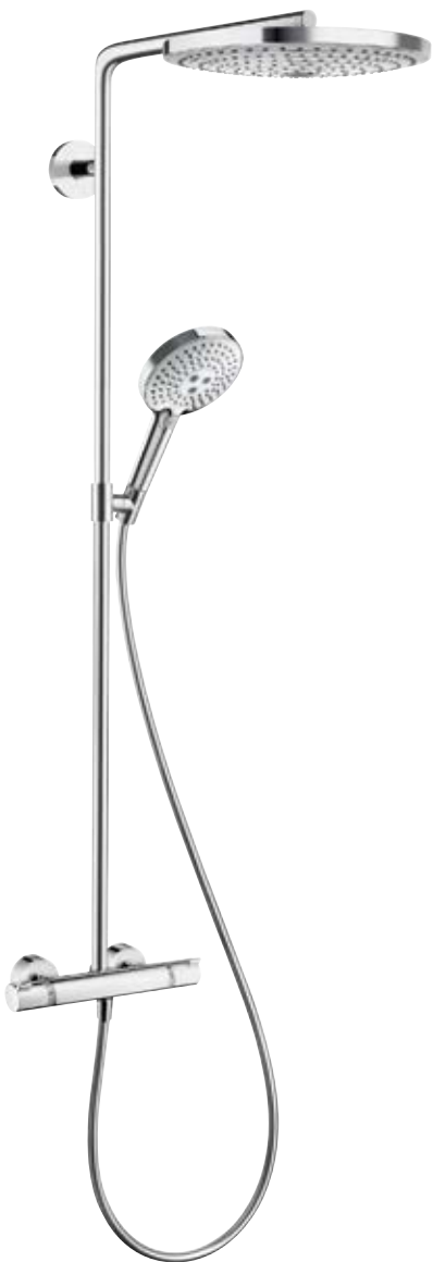
Raindance® Select S 300 2jet Showerpipe s rotirajućim Raindance Select S 300 2jet nadglavnim tušem (15 l/min), Raindance Select S 120 3jet ručnim tušem (16 l/min) i Ecostat Comfort termostatom, držač tuša 460 mm # 27133, -000, -400 Visina uzlazne cijevi je podesiva
