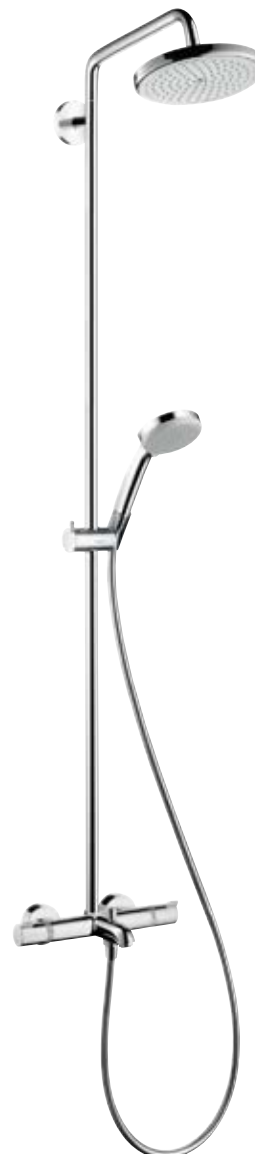
Croma® 220 Air 1jet Showerpipe s rotirajućim nadglavnim tušem Croma 220 Air 1jet (17 l/min), ručnim tušem Croma 100 Vario (15 l/min) i termostatom za kade Ecostat Comfort (20 l/min), ručkom tuša 400 mm # 27223, -000 Visina uzlazne cijevi je podesiva
