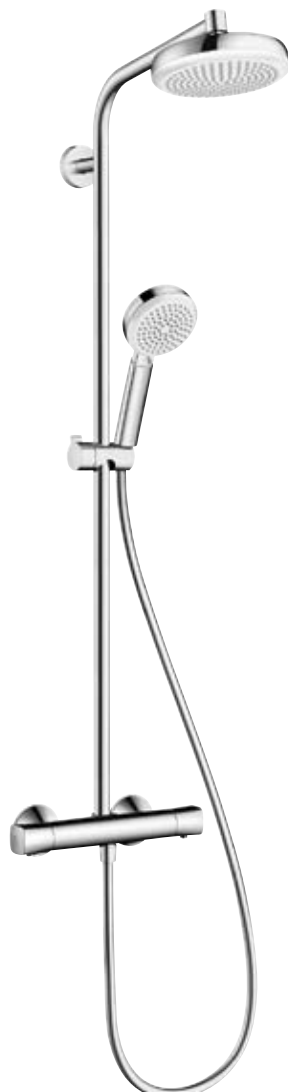
Crometta® 160 1jet Showerpipe s Crometta 160 1jet nadglavnim tušem, Crometta 100 Vario ručnim tušem i Ecostat Universal termostatom # 27264, -400 # 27265, -400 (9 l/min) EcoSmart Visina uzlazne cijevi je podesiva
